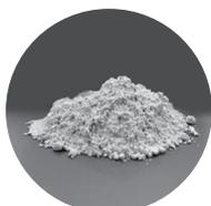
\*製鉄所の高炉から排出された熔融状態のスラグを高速の水や空気で急冷し、微細に粉砕したものです。
