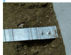
規格：一般構造用圧 (JIS G3101 S5400) 記号：SS400 に垂鉛めっきを施したもの (溶融垂鉛めっき JIS H8641 に示す HDZ50)
